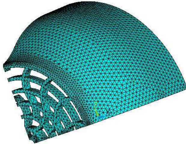
Figura 6.17 – Modelo de elementos finitos de um setor de 90° da defletora.
