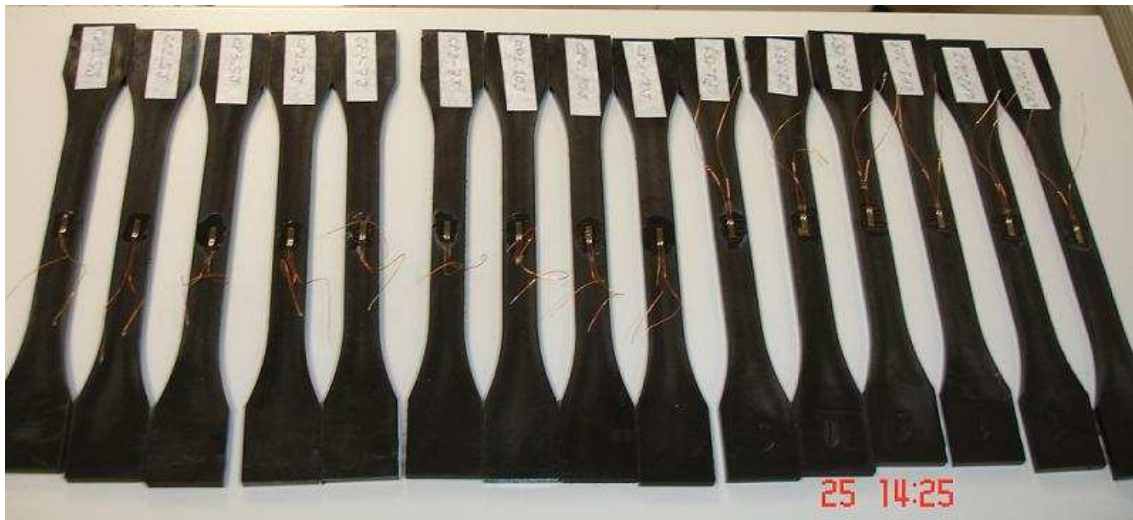
Figura 5.9 – Corpos de prova de PP preparados para os ensaios.
