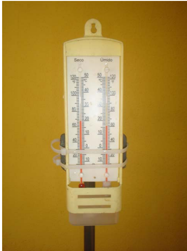
Foto 4.1: Psicrômetro de ventilação natural.
