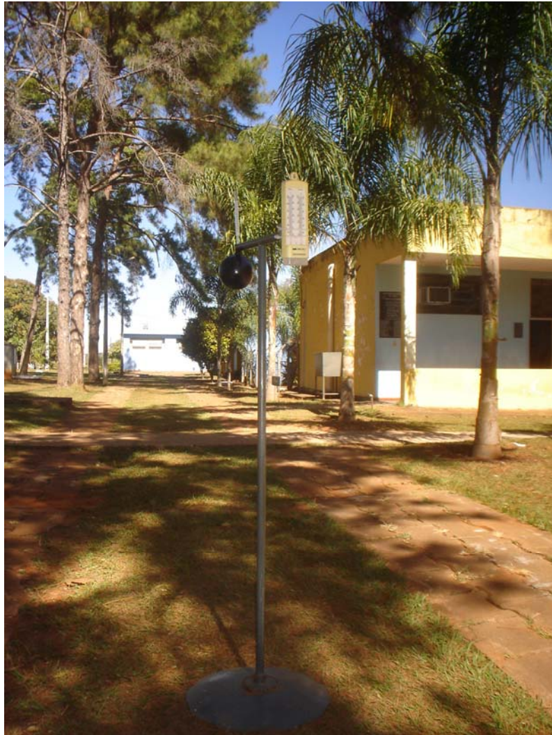
Foto 4.3: Conjunto de termômetros composto do psicrômetro de ventilação natural e do termômetro de bulbo seco inserido no de globo negro. Detalhe da altura do equipamento a 1,30 m.
