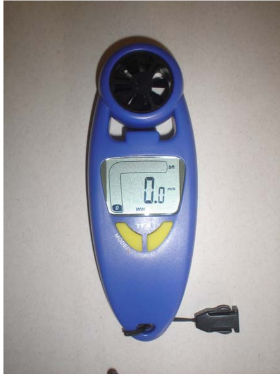
Foto 4.4: Anemômetro digital portátil.
