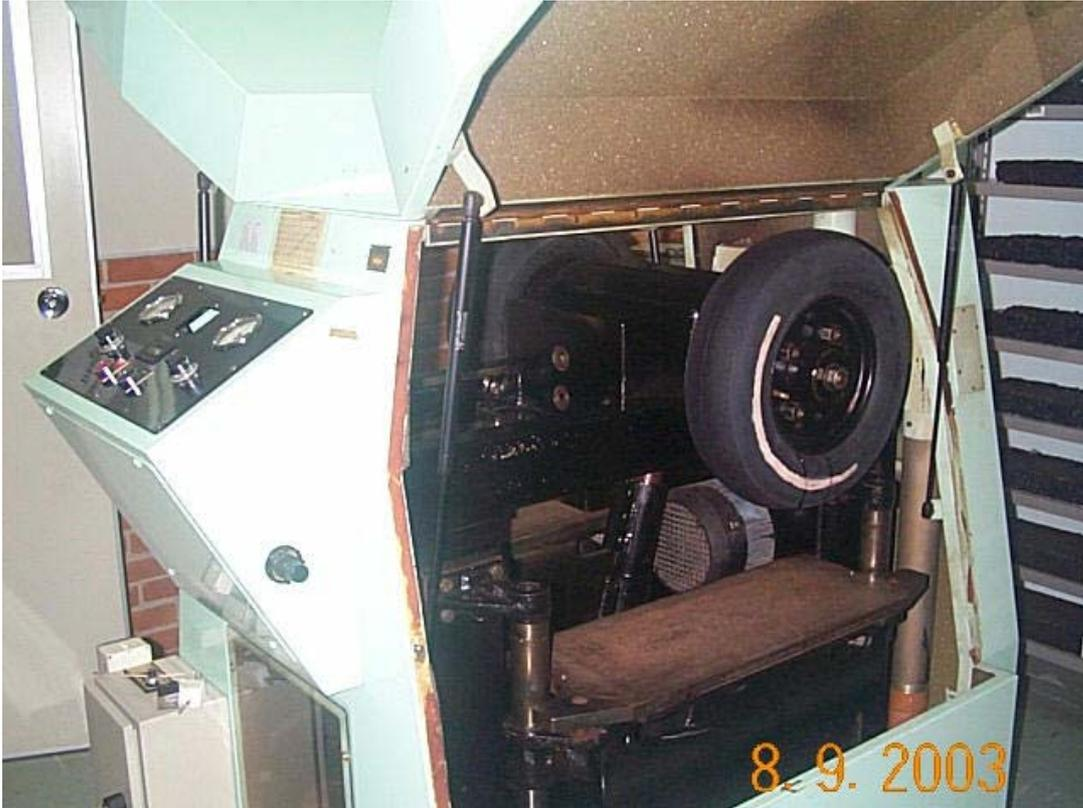
Figura 2.12 – Detalhe do simulador de tráfego LPC da EPUSP.
