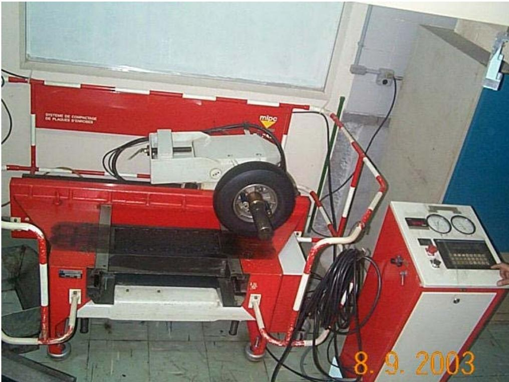
Figura 2.10 – Compactador pneumático para moldagem de placas para ensaio no simulador LPC do laboratório de pavimentação da EPUSP.
