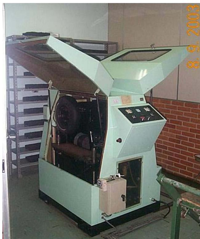
Figura 2.11 – Simulador de tráfego LPC para avaliação da deformação permanente no laboratório de pavimentação da EPUSP.
