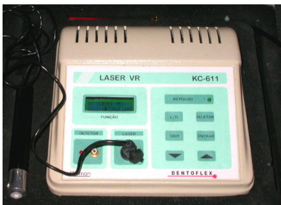
Figura 3. Aparelho de laser diodo semiconductor de AsGaAl. Fonte: Dados da pesquisa (UFPB-UFBA, 2008).
