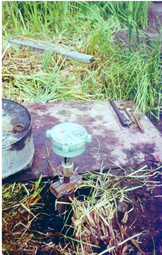
Foto 2 – Detalhe da mesa de torque utilizada no ensaio de palheta.
