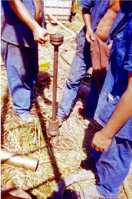
Foto 3 – Montagem do pistão utilizado na retirada de amostras Osterberg.
