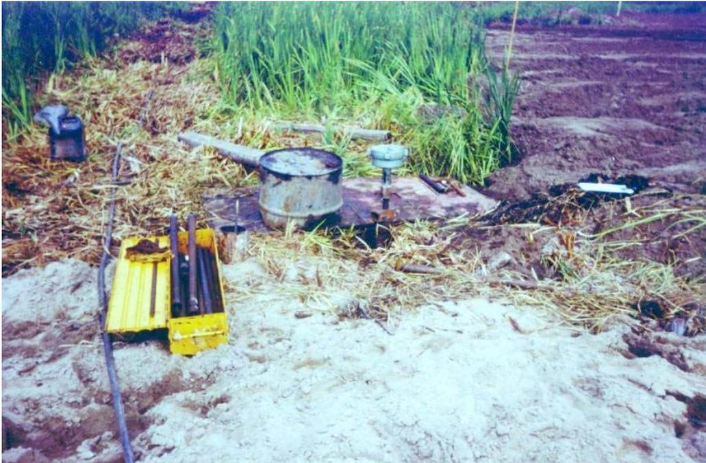
Foto 1 – Equipamento utilizado no ensaio de palheta.
