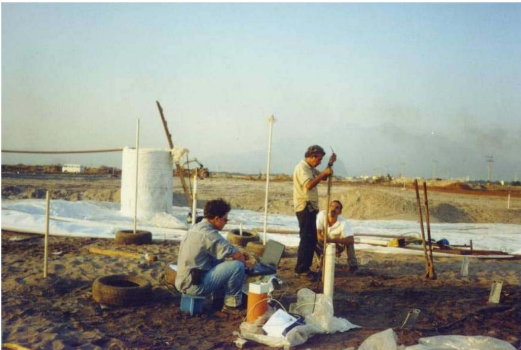
Foto 14 – Ensaio de permeabilidade “in situ” e leitura dos instrumentos na estação instrumentada E1.
