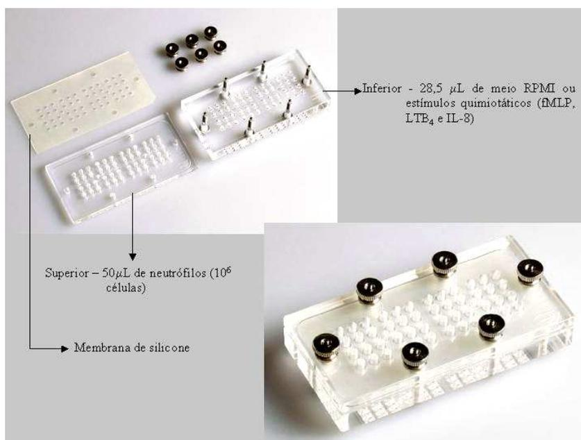
**Figura 7.** Microcâmara de quimiotaxia. Apresentação das partes da microcâmara de quimiotaxia: câmara inferior, membrana de silicone e câmara superior
