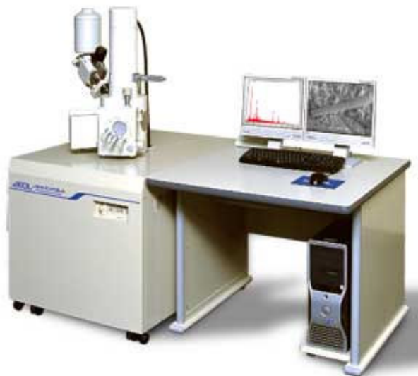
Figura 21 : Foto de MEV JEOL com sistema de micro-análise.
