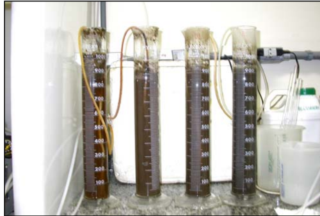
Figura 3.5 – Reatores utilizados no tratamento biológico em batelada.
