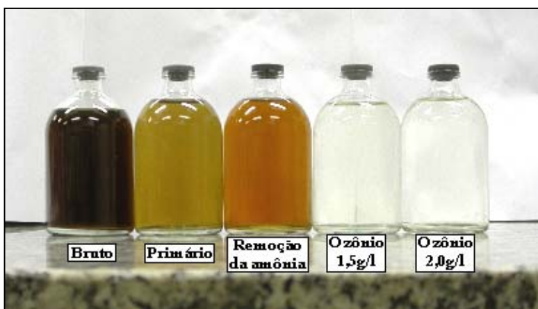
Figura 4.5 – Foto do chorume nas etapas de tratamento.
