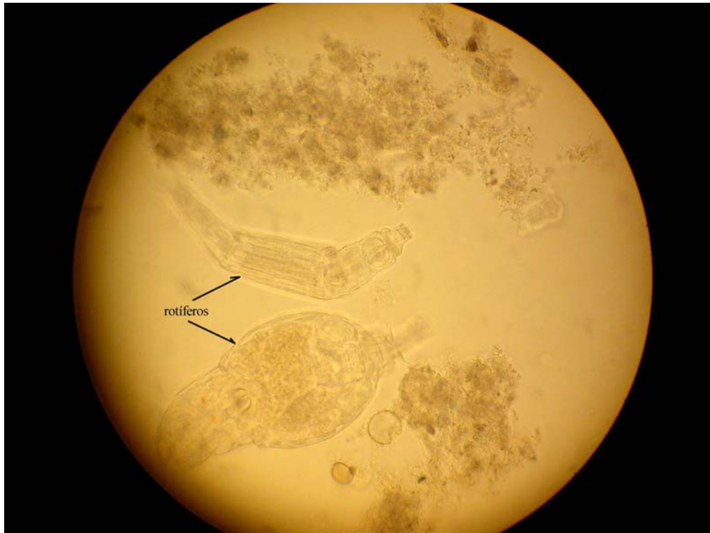
Figura 4.14 – Presença de protozoários no lodo da ETE (aumento 400x)
