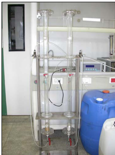
Figura 3.2 – Planta piloto do processo de ozonização
