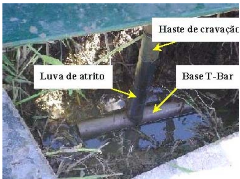
Figura 4.4 –Penetrômetro cilíndrico em fase inicial de ensaio.
