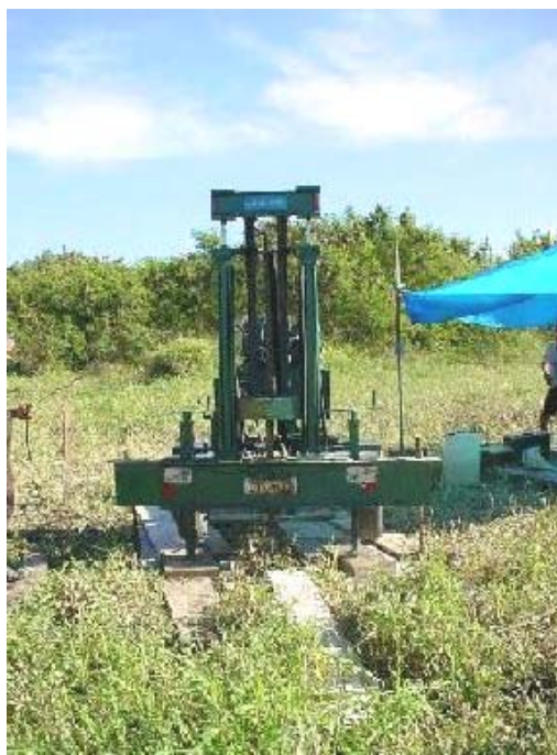
Figura 4.3 – Máquina de cravação do penetrômetro cilíndrico/piezocone utilizada pela COPPE/UFRJ.
