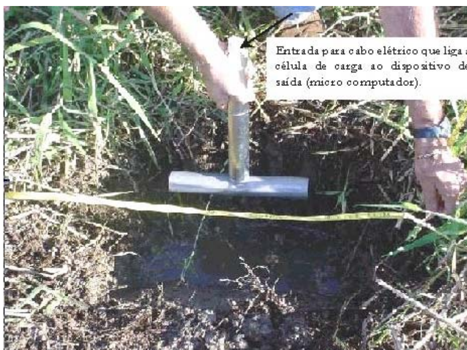
Figura 4.1 – Penetrômetro cilíndrico produzido a partir do piezocone COPPE III.
