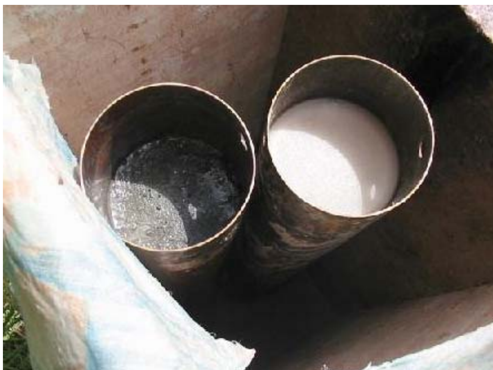
Figura 3.6 – Amostra sem parafina (à esquerda) e com parafina (à direita), segunda campanha.
