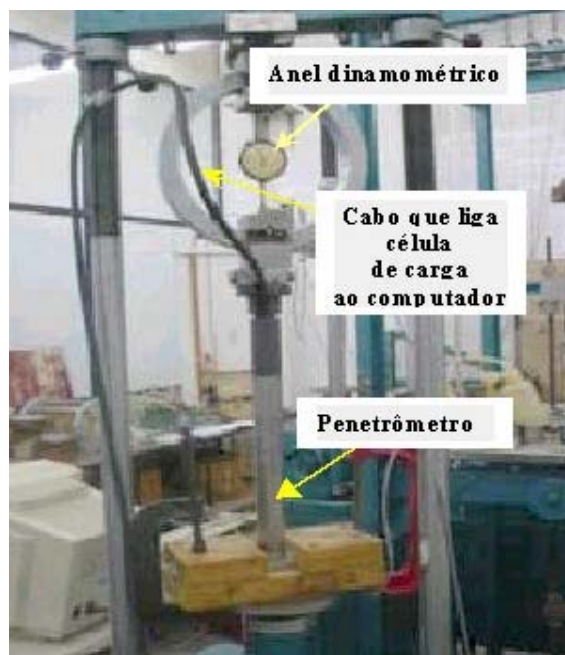
Figura 4.2 – Calibração da ponta do penetrômetro cilíndrico
