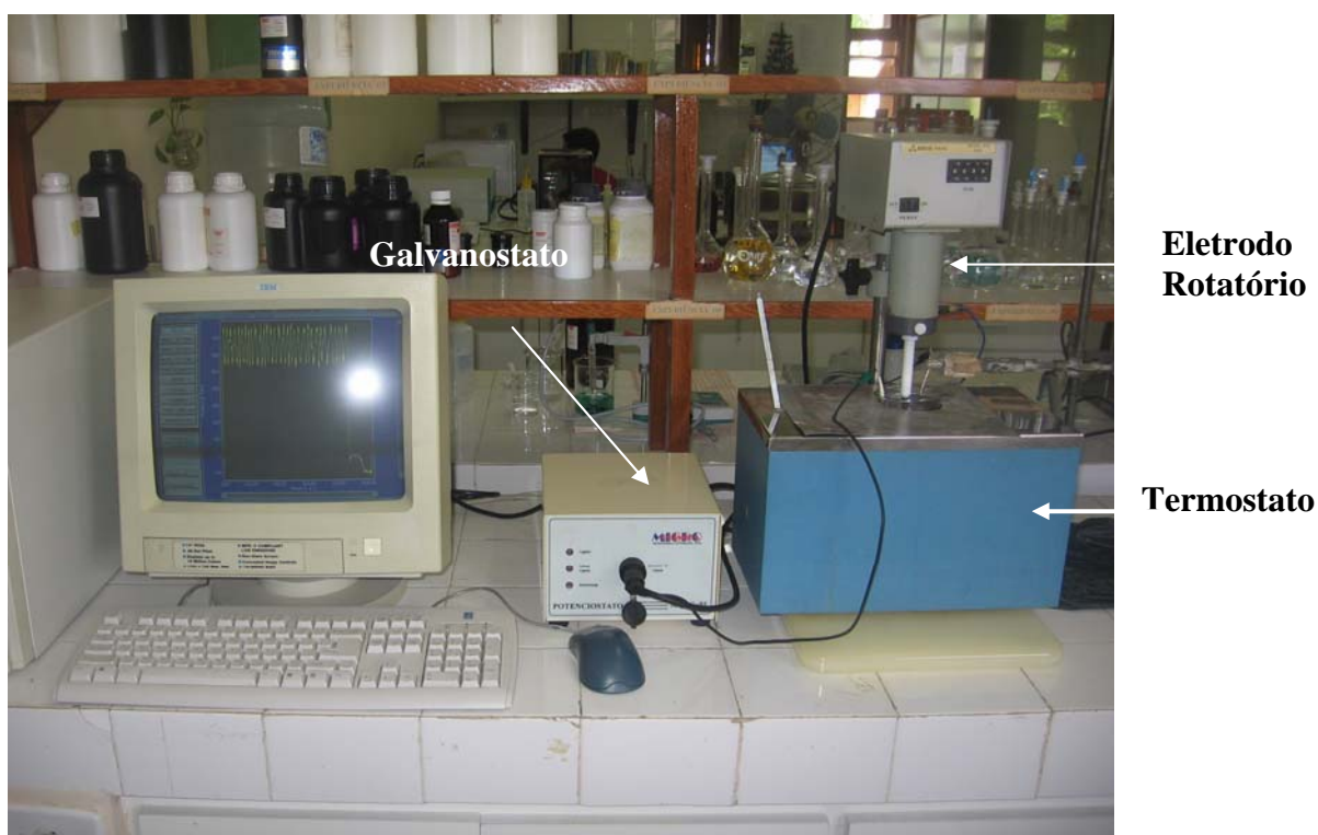
Figura 05 - Equipamentos utilizados na eletrodeposição.
