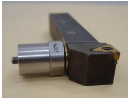
Figura 5.2 – Acelerômetro acoplado no porta-ferramenta.
