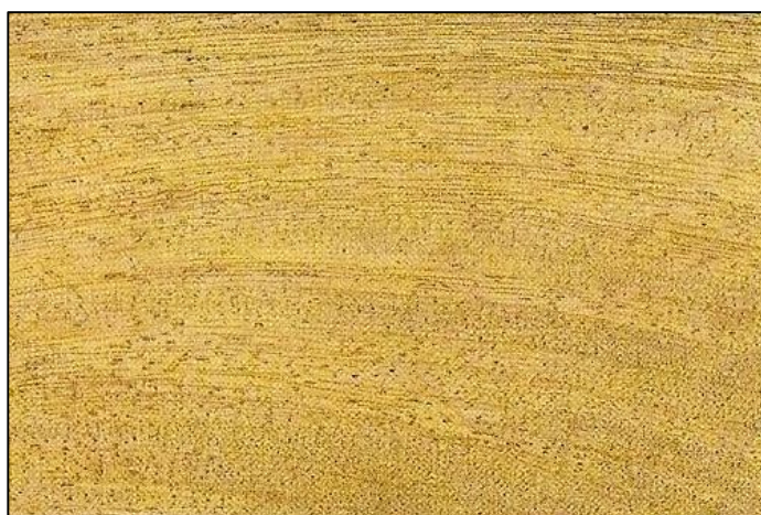
Figura 3. Aspecto da madeira de angelim.
