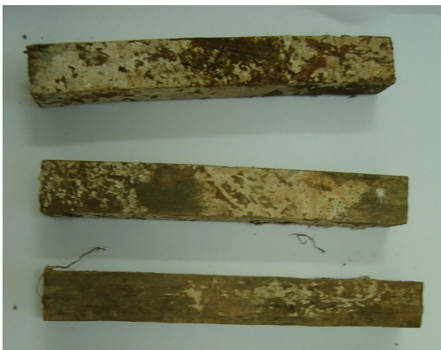
Figura 9. Estacas danificadas por Coptotermes gestroi com infestação por fungo Basidiomiceto.
