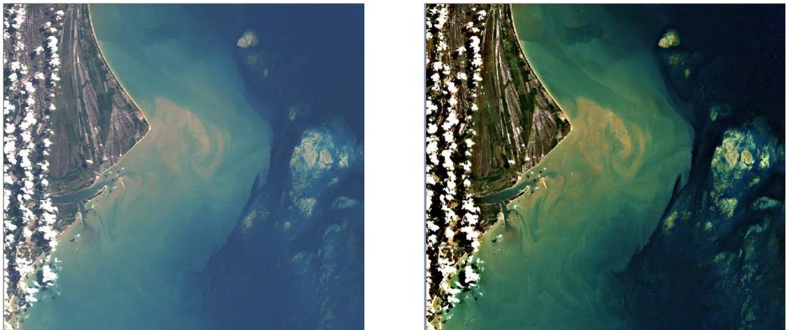
Figura 12: Imagem ETM 01 em composição colorida 1(azul), 2(verde) e 3(vermelho), antes (esquerda) e após (direita) a aplicação da correção atmosférica.
