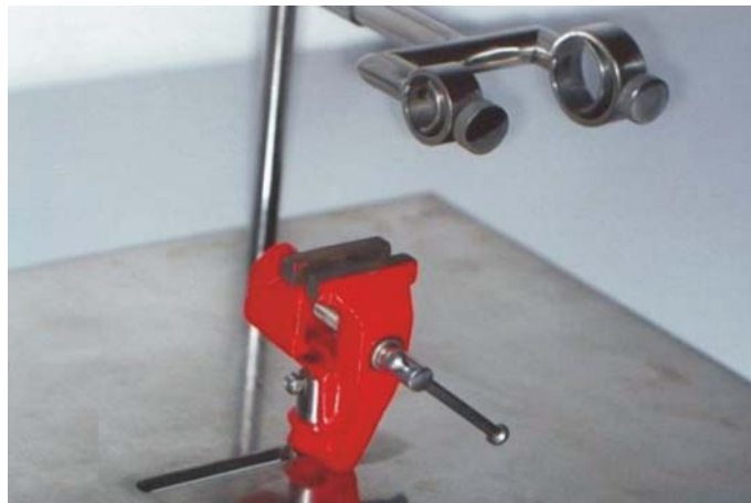
FIGURA 8 – Dispositivo empregado para fixação do canal artificial e do motor para realização do ensaio de flexão rotativa proposto por Moreira (2006)
