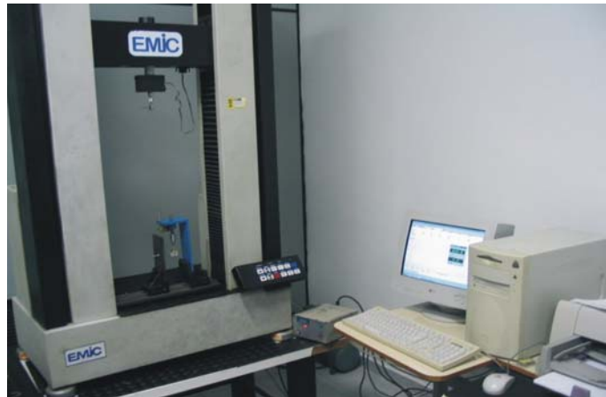
FIGURA 3 - Máquina de Ensaio Universal EMIC-DL 10.000 (Emic Equipamentos e Sistemas de Ensaio Ltda - Paraná, Brasil)
