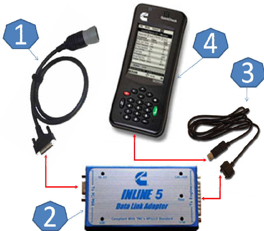
Figura 2.3 Sistema de leitura de DTC do sistema OBD do veículo.
