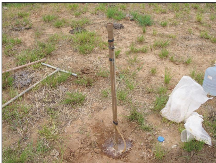
Figura 3.6 – Piezômetro instalado no campo.
