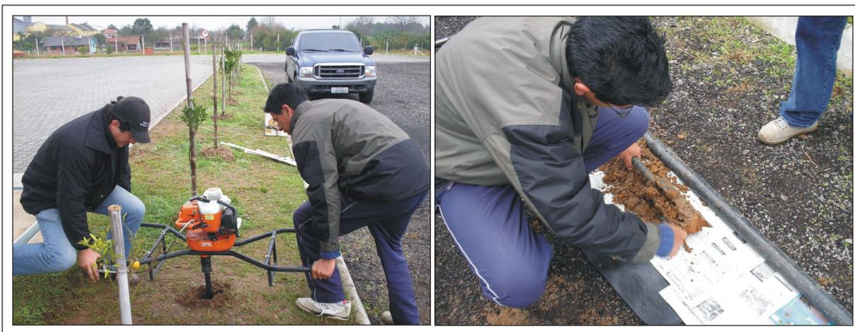
Figura 3.8 – Execução do furo com trado mecânico e coleta de material.
