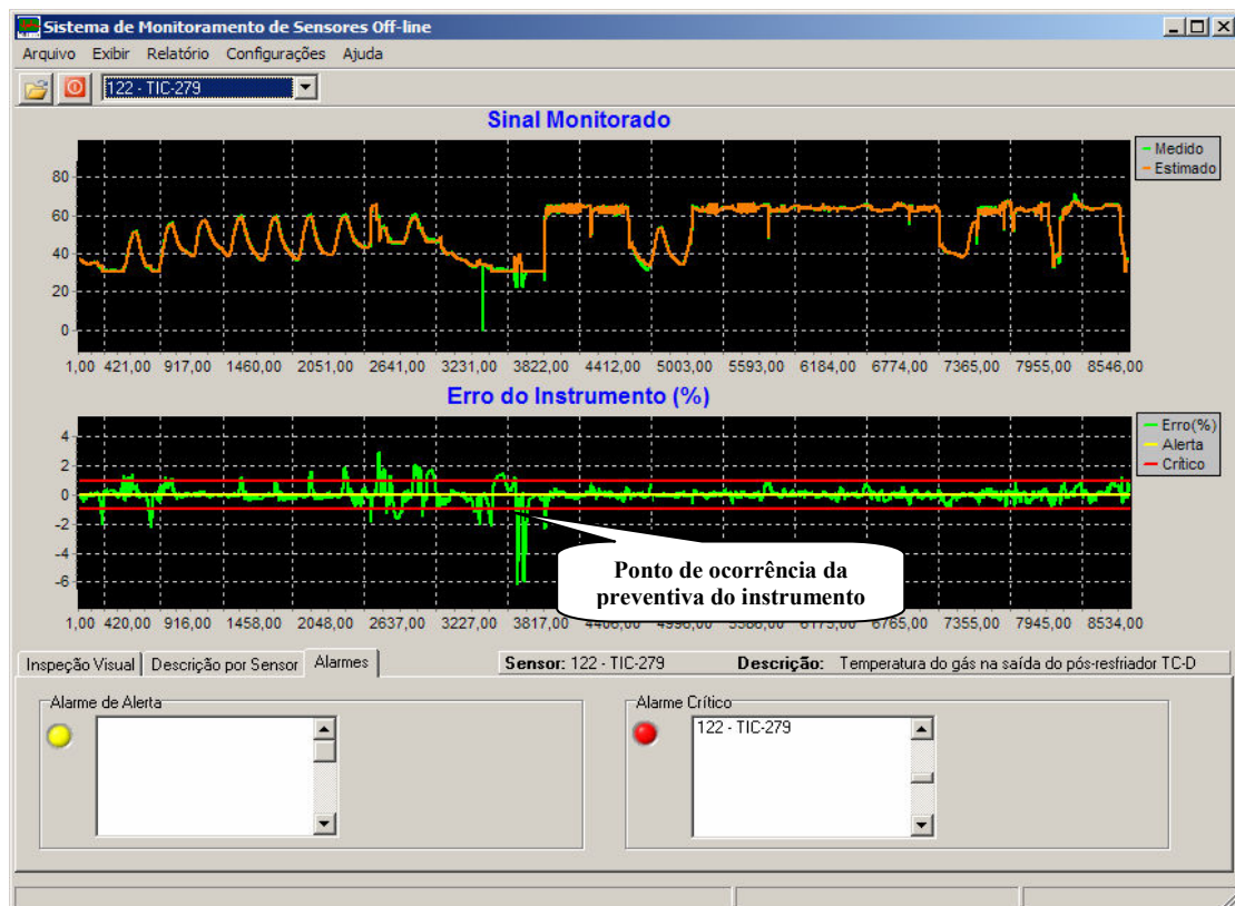
Figura 6.12 – Manutenção preventiva sem reincidência do problema.
