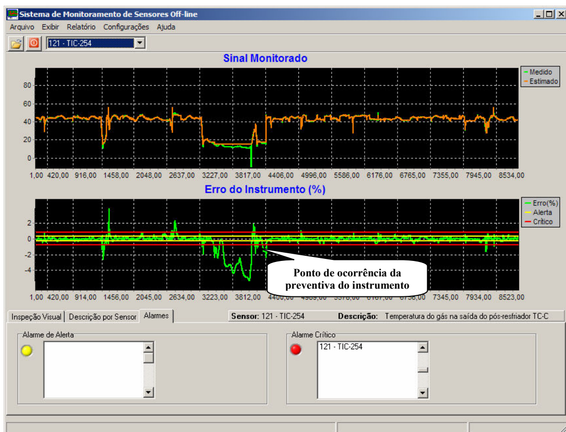
Figura 6.16 – Manutenção preventiva com reincidência do problema.
