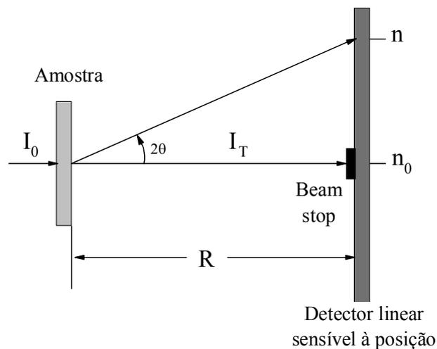
Figura 19: Visão lateral da montagem experimental.
