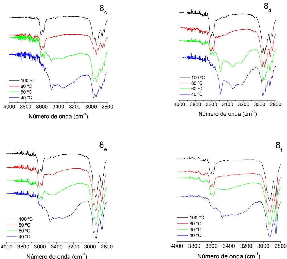
Figura 34: Espectros de transmitância no infravermelho com variação de temperatura para os géis dos compostos  $8_c$ ,  $8_d$ ,  $8_e$  e  $8_f$  em tetracloretoileno e na concentração de  $0,01 \text{ g mL}^{-1}$ .
