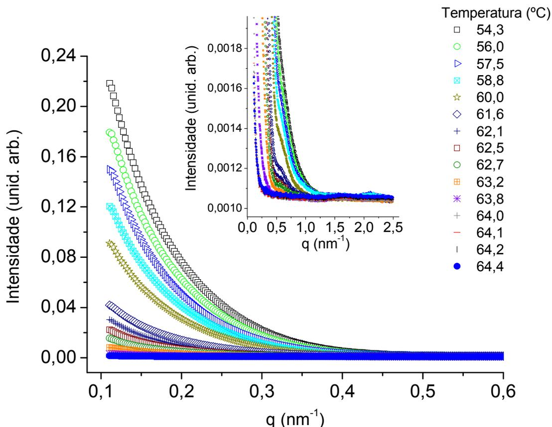
Figura 26: Intensidade de espalhamento de raios-X a baixos ângulos em função da temperatura para o gel do composto  $8_c$  em 1-butanol na concentração de  $0,05 \text{ g mL}^{-1}$ . No destaque a ampliação da região de baixas intensidades, até  $q_{\text{máx}} = 2,6 \text{ nm}^{-1}$ .
