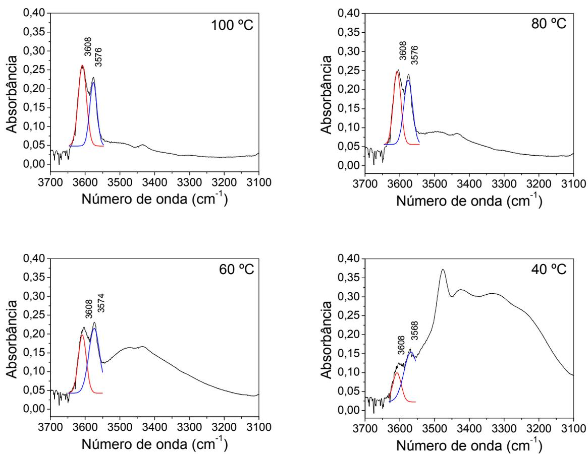
Figura 37: Separação de sinais superpostos do espectro de absorção no infravermelho, em diferentes temperaturas, para o gel do composto  $\delta_e$  em tetracloretileno e concentração de  $0,01 \text{ g mL}^{-1}$ .
