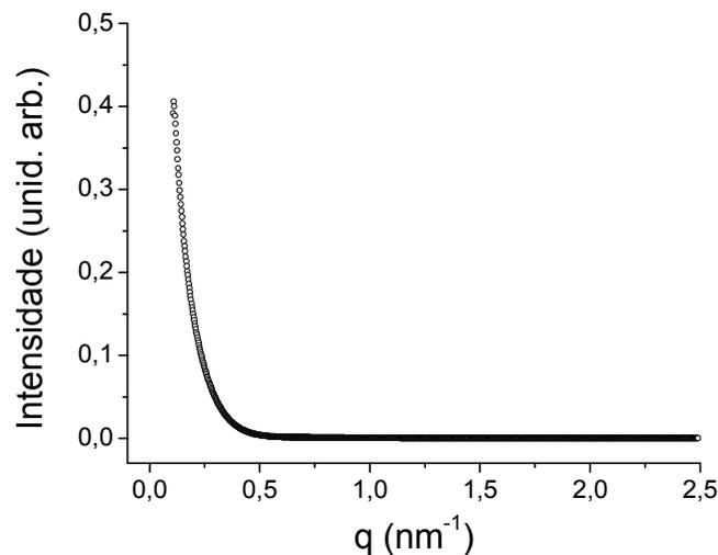
Figura 25: Intensidade de espalhamento de raios-X a baixos ângulos em função do vetor de onda para o gel do composto  $\delta_c$  em 1-butanol e concentração de  $0,05 \text{ g mL}^{-1}$  na temperatura ambiente.
