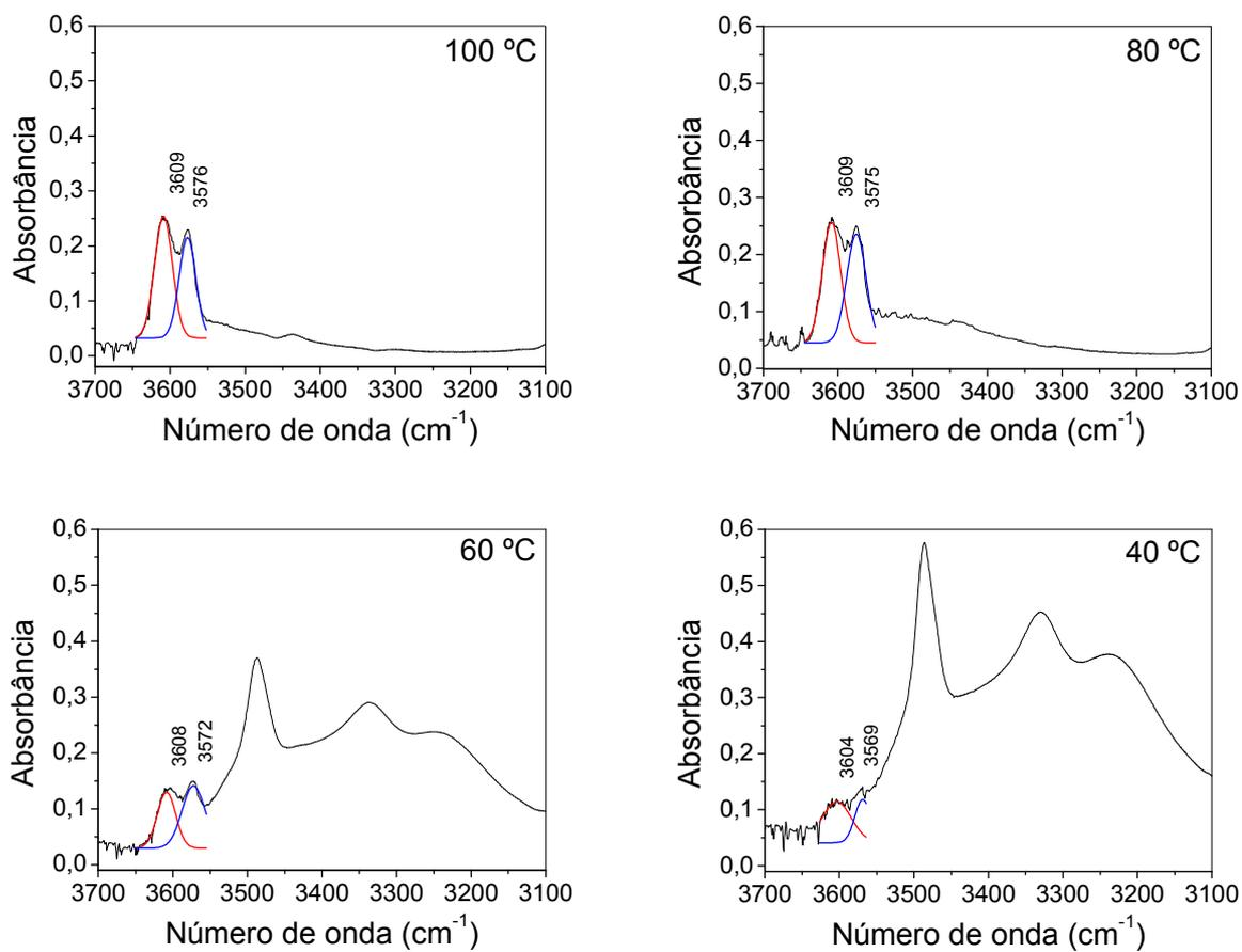
Figura 36: Separação de sinais superpostos do espectro de absorção no infravermelho, em diferentes temperaturas, para o gel do composto  $8_d$  em tetracloretileno e concentração de  $0,01 \text{ g mL}^{-1}$ .
