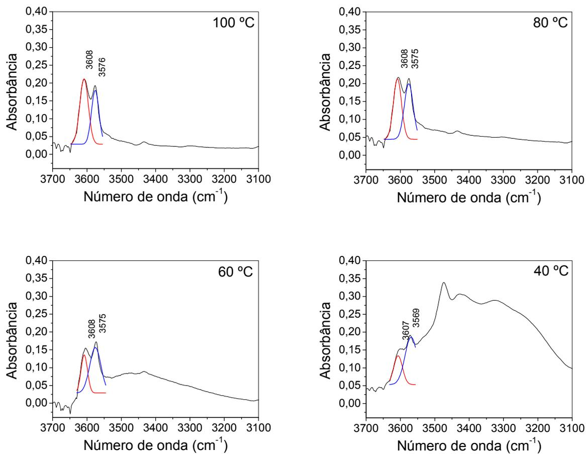
Figura 38: Separação de sinais superpostos do espectro de absorção no infravermelho, em diferentes temperaturas, para o gel do composto  $8_f$  em tetracloretileno e concentração de  $0,01 \text{ g mL}^{-1}$ .
