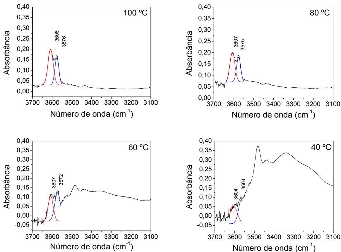
Figura 35: Separação de sinais superpostos do espectro de absorção no infravermelho, em diferentes temperaturas, para o gel do composto  $\delta_c$  em tetracloretileno e concentração de 0,01 g mL<sup>-1</sup>.
