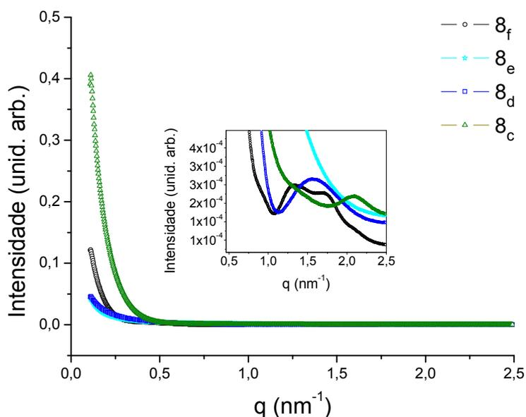
Figura 30: Intensidade de espalhamento de raios-X a baixos ângulos em função do vetor de onda ( $q$ ) para os géis dos compostos  $\delta_{c-f}$  na concentração de  $0,05$  g mL<sup>-1</sup> em 1-butanol. Em destaque, ampliação da região de baixa intensidade.
