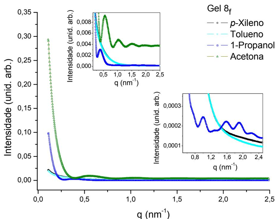
Figura 28: Intensidade de espalhamento de raios-X a baixos ângulos a temperatura ambiente (24 °C) em função do vetor de onda ( $q$ ) para o gel do composto  $8_f$  na concentração de  $0,02 \text{ g mL}^{-1}$  em vários solventes. Em destaque estão as ampliações da região de baixa intensidade.
