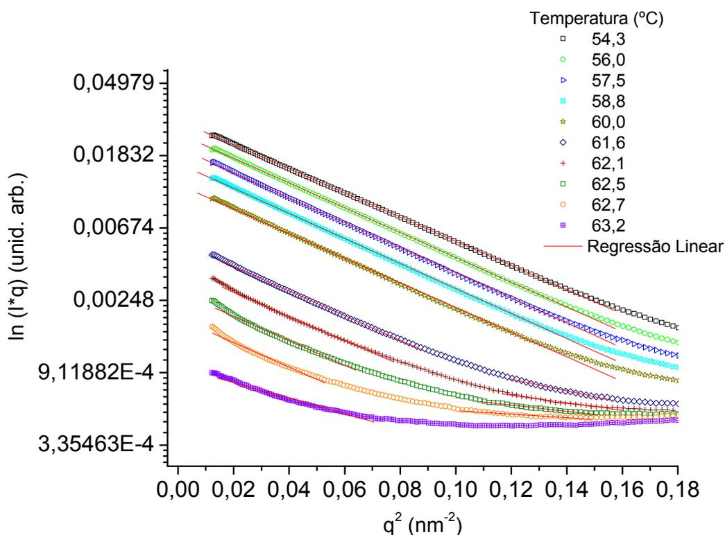
Figura 27: Curvas de Guinier para o gel do composto 8<sub>c</sub> em 1-butanol na concentração de 0,05 g mL<sup>-1</sup>, em função da temperatura.
