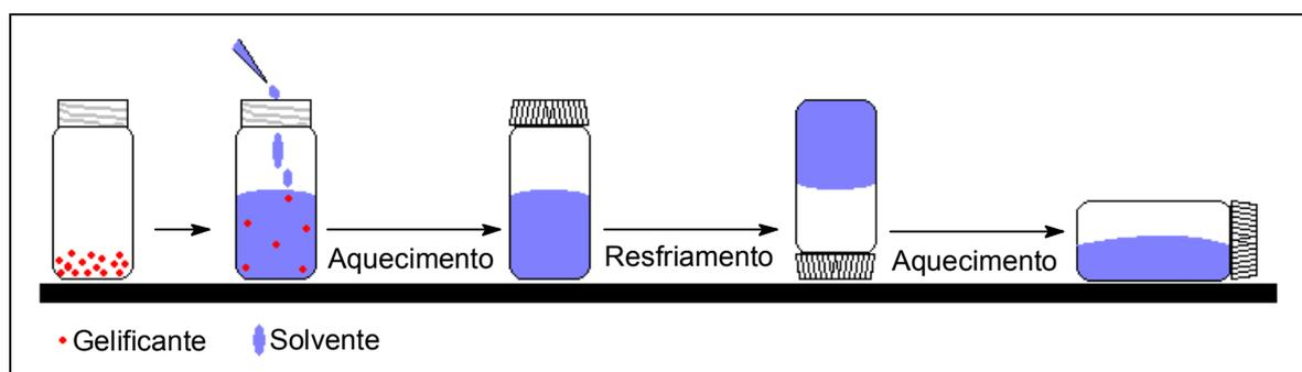
Figura 5: Esquema representativo de um teste de gelificação.
