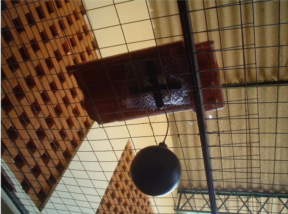
Figura 9 – Globo Negro e “Data Logger” para mensuração de temperatura e umidade.
