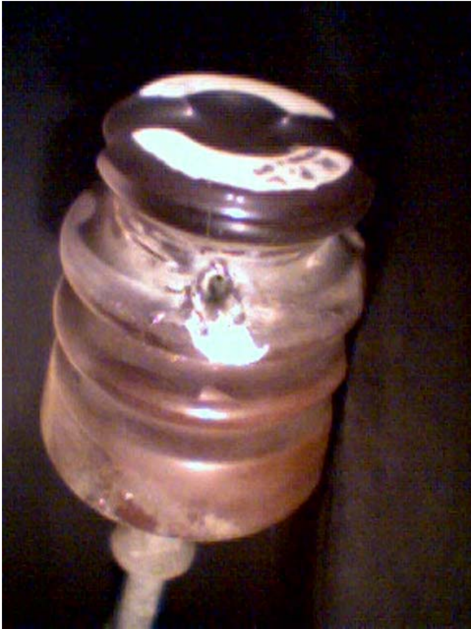
Fig. 3.1. Isolador de pino classe 15 kV com perfuração.
