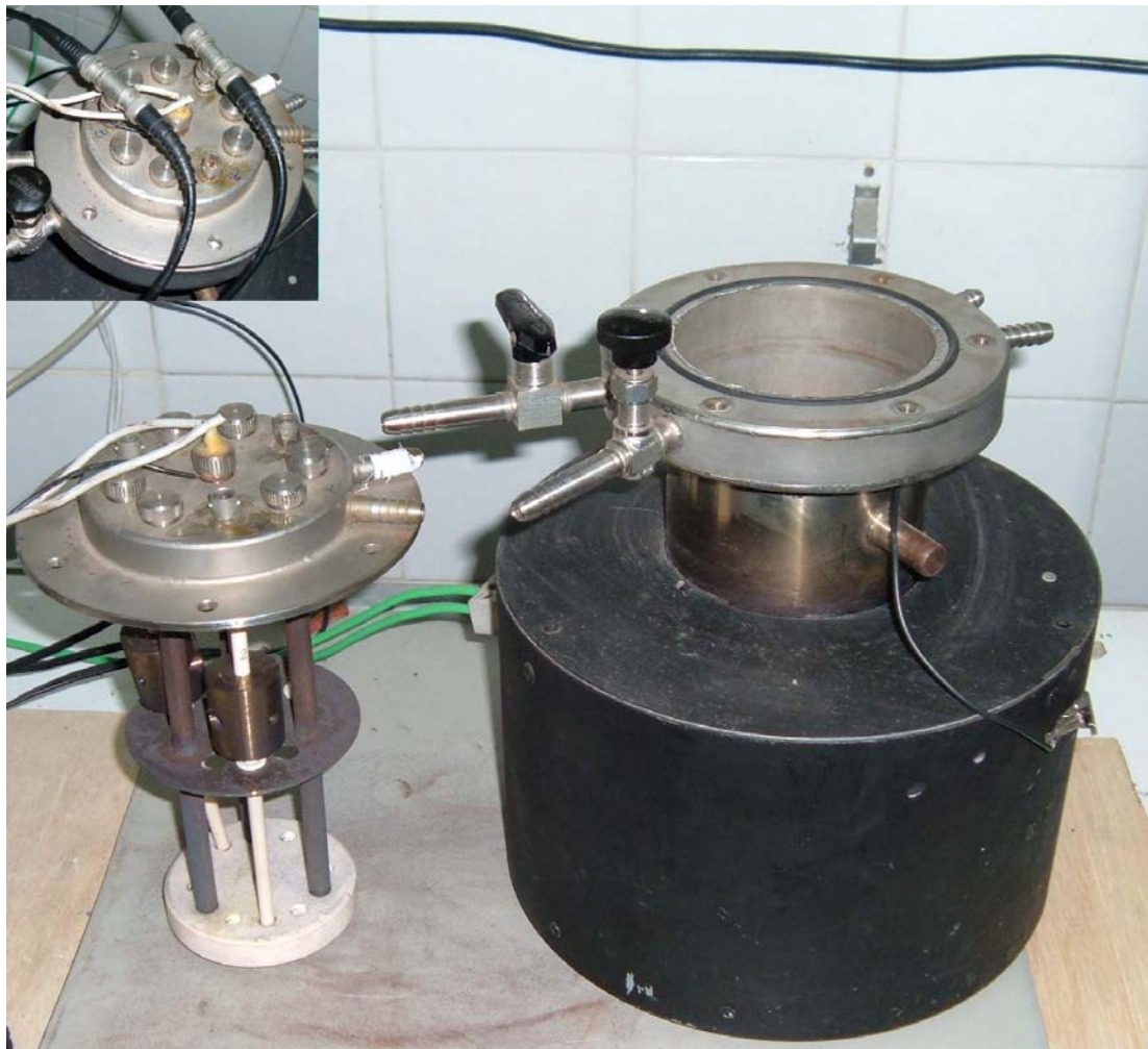
Fig. 3.6. Porta amostras e forno utilizado nas medições de espectroscopia de impedância. No detalhe as conexões para o impedancímetro.
