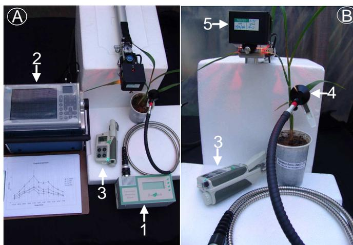
Figura 01. Aparelhos usados nas análises fisiológicas. (A) Visão geral dos aparelhos utilizados para análise de fluorescência da clorofila a (1, fluorímetro modelo FMS-2), trocas gasosas (2, IRGA, CIRAS-2) e intensidade de cor verde da folha (3, SPAD). (B) Visão detalhada dos aparelhos em contato com a planta: (4) sonda do fluorímetro acoplada à pinça de adaptação ao escuro e (5) câmara de medição do IRGA.
