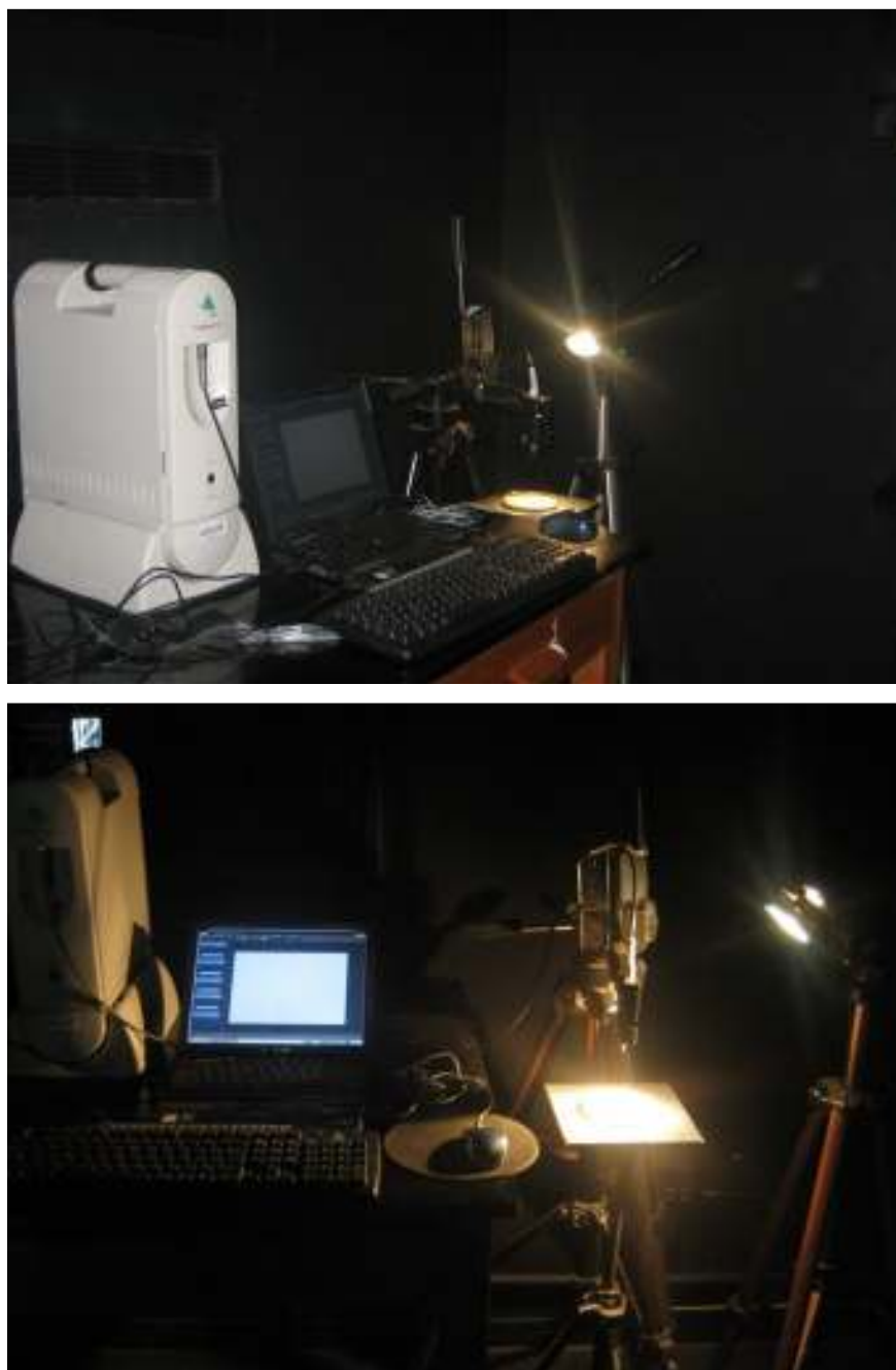
Figura 1 – Aquisição dos dados radiométricos através do Sensor FieldSpec
