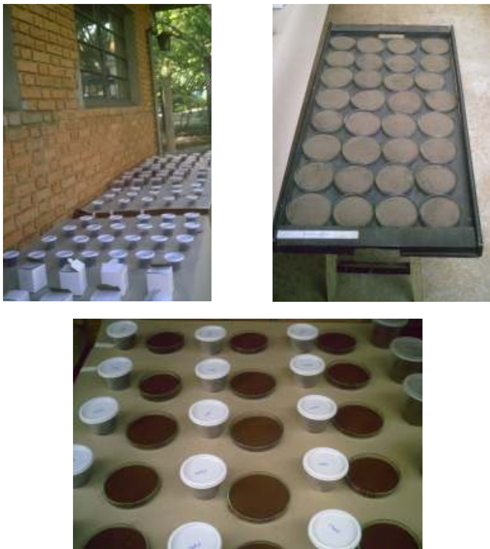
Figura 1 – Preparação das amostras de terra para posterior avaliação no sensor FieldSpec
