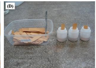
Figura 4A - Preparo das tiras de papel de filtro impregnadas com óxido de ferro: (A) Papel de filtro secando após a imersão em solução de cloreto de ferro; (B) Procedimento de amonificação; (C) Papel de filtro após a amonificação; (D) Emprego das tiras na extração de fósforo
