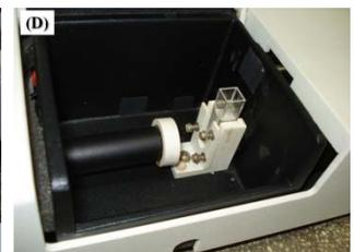
Figura 5A - Leituras de fósforo pelo método colorimétrico: (A) Curva de calibração; (B) Amostras preparadas para leitura; (C) Ajuste do espectrofotômetro com a curva de calibração e; (D) Detalhe da leitura de uma amostra
