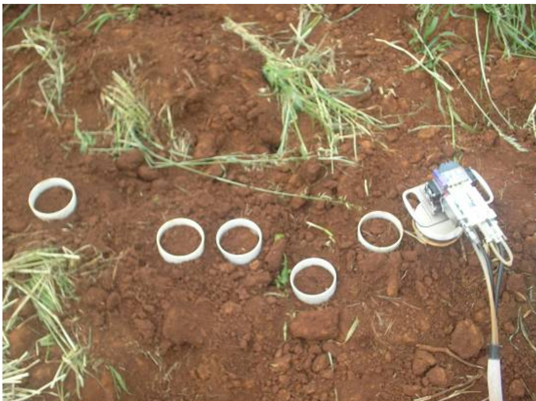
FIGURA 3 – Anéis de PVC instalados no solo após a atividade de lavração e LI-6400-09 realizando a leitura da emissão instantânea de \text{CO}_2 .
