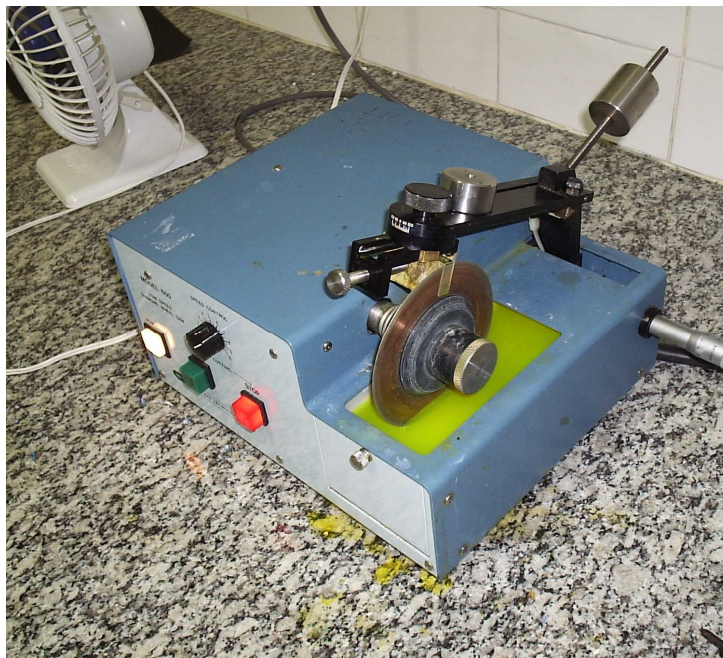
Figura 3.5.1: processo de fatiamento do vidro.
