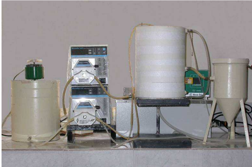
Figura 4.2. Unidade laboratorial do sistema de lodos ativados convencional utilizado durante o Experimento I.
