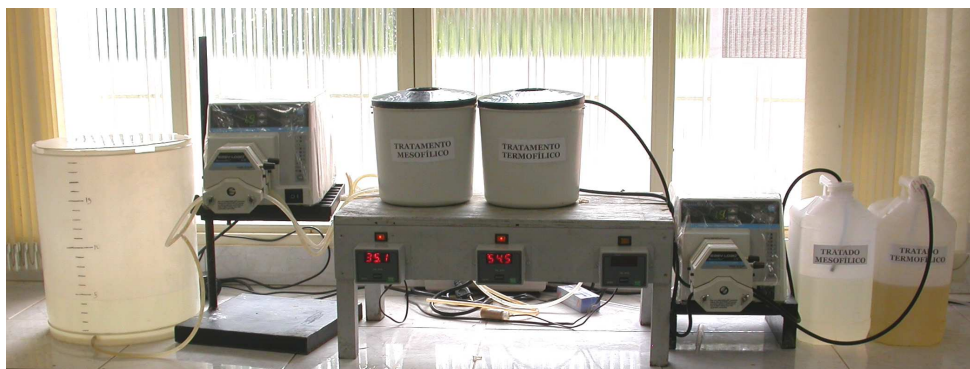
Figura 4.9. Fotografia das plantas pilotos laboratoriais composta por dois biorreatores a membranas utilizadas durante o Experimento III.
