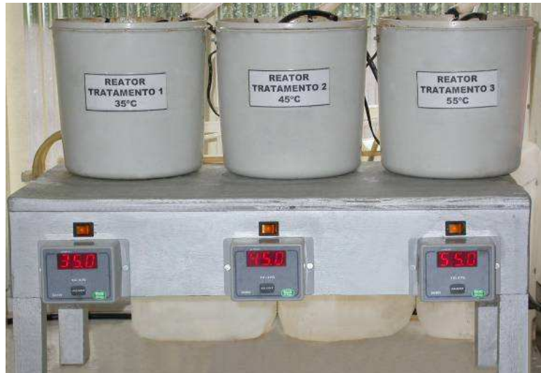
Figura 4.6. Fotografia das plantas piloto laboratoriais composta por três biorreatores a membranas nas temperaturas de 35, 45 e 55 °C do Experimento II.
