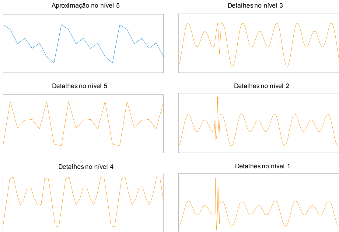
Figura 59 - Aproximação em 5 níveis da forma de onda presente na Figura 58 e obtida através da transformada discreta wavelet implementada
