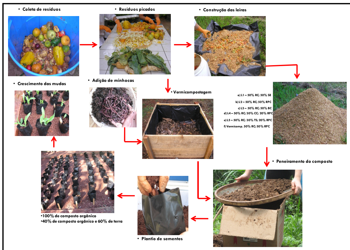
Figura 3.5 – Sequência dos procedimentos experimentais realizados na compostagem e na vermicompostagem e da aplicação do composto produzido
