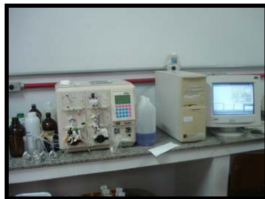
Figura 9 - Aparelhos utilizados para análises químicas, fotômetro de chama (a) e FIA – Flow Injection Analysis (b)
