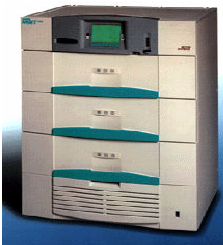
Figura 14: Versão automatizada do sistema manual MGIT - Bactec MGIT 960
