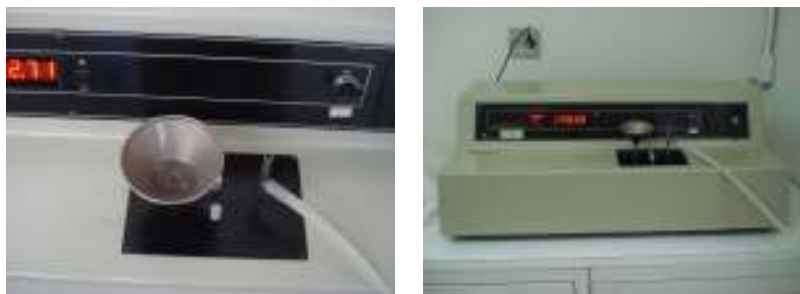
Figura 11 - Leitura do caldo em sacarímetro
