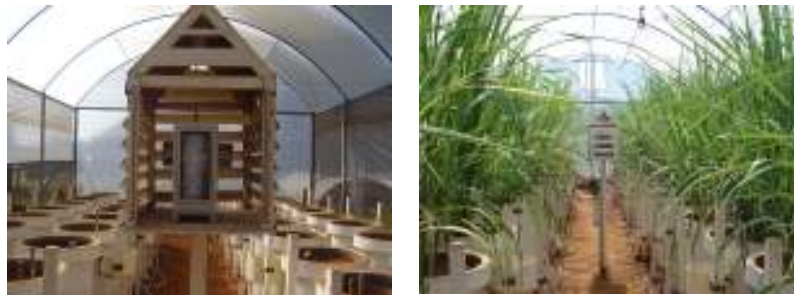
Figura 3 - Termohigrógrafo instalado no centro da estufa em abrigo meteorológico.
