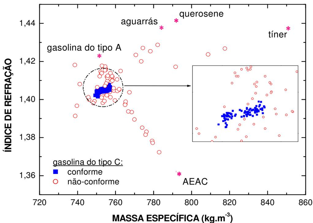
Figura 27 - Correlação entre o índice de refração, mensurado com o refratômetro de Abbe, e a massa específica de amostras de gasolina do tipo C conformes e não-conformes.
