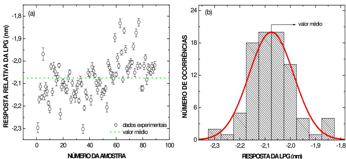
Figura 24 - Respostas relativas da LPG quando em contato com amostras de gasolina do tipo C conformes (a), e; histograma de frequências dessa resposta (b).
