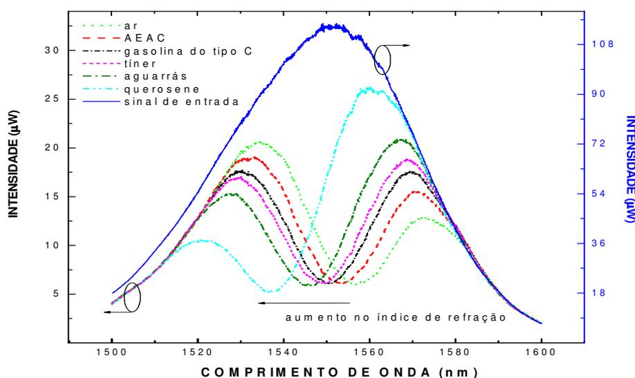
Figura 11 - Espectros de transmissão da LPG, em escala linear, quando imersa em diferentes substâncias.
