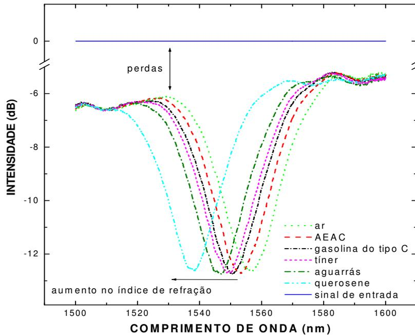
Figura 12 - Espectros de transmissão da LPG, normalizados em escala logarítmica, quando imersa em diferentes substâncias.
