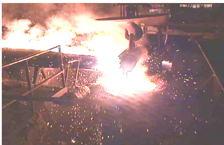
Figura 9 – Vazamento do aço do forno elétrico para a panela
