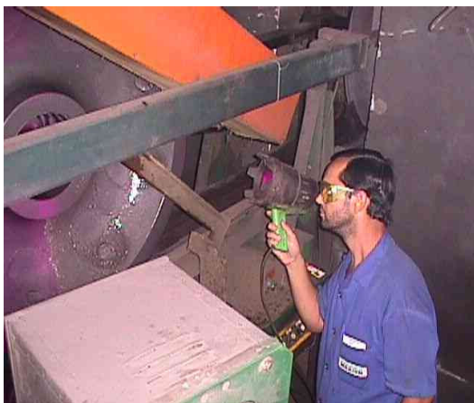
Figura 12 – Ensaio de partículas magnéticas
