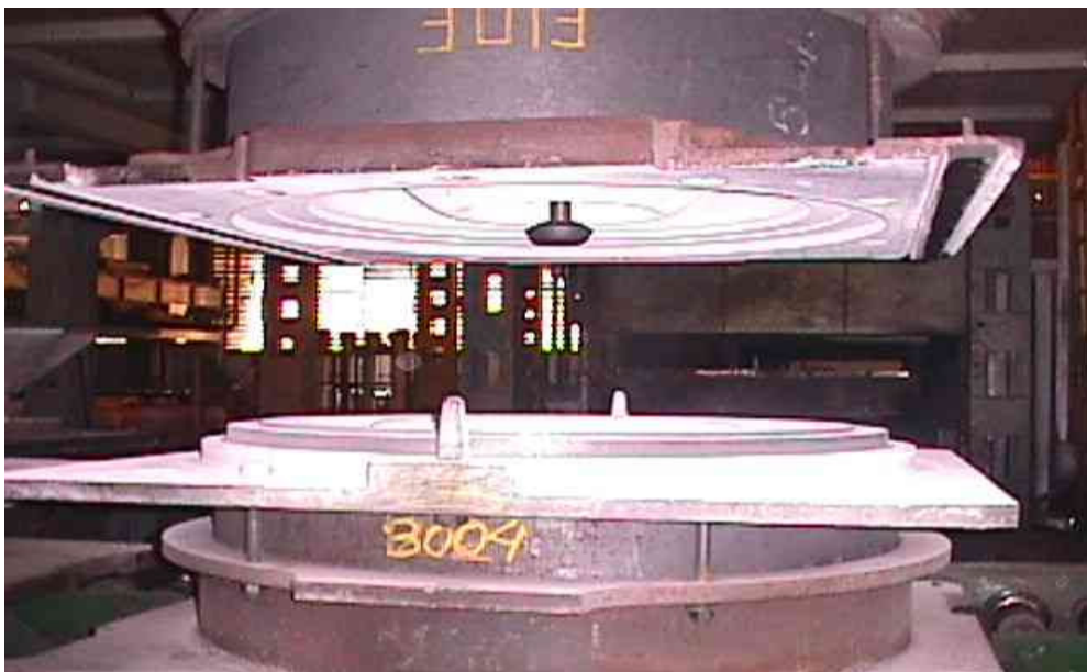
Figura 10 – Molde tampa e molde fundo durante a operação de fechamento
