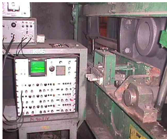
Figura 13 – Ensaio de ultra-som
