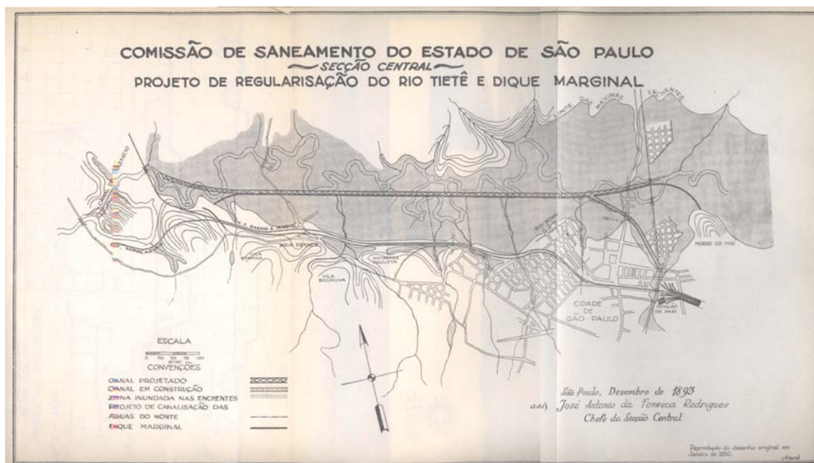
Ilustração 4 – Projeto de retificação do rio Tietê proposto por Saturnino de Brito Fonte: SILVA, Lysandro Pereira da. Comissão de Melhoramentos do Rio Tietê. 1950.
