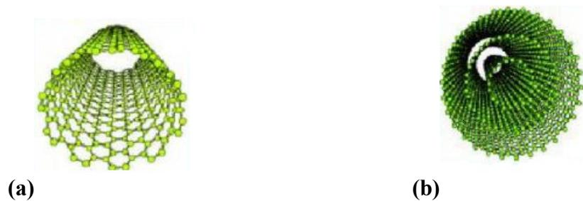
**Figura 2:** (a) nanotubo de parede simples, (b) nanotubo de paredes múltiplas, (adaptado de DRESSELHAUS et al., 1998).
