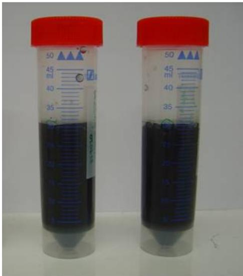
**Figura 10:** Amostra de NTC (100 mg) após tratamento por via úmida em meio ácido com aquecimento por radiação de microondas.
