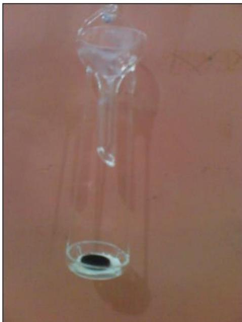
**Figura 8:** Suporte de quartzo empregado na combustão iniciada por microondas e amostra de NTC após a etapa de prensagem.
