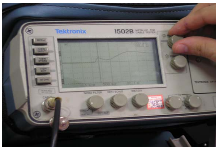
Figura 12. Osciloscópio marca Tektronix, tipo TDR, modelo 1502B.
