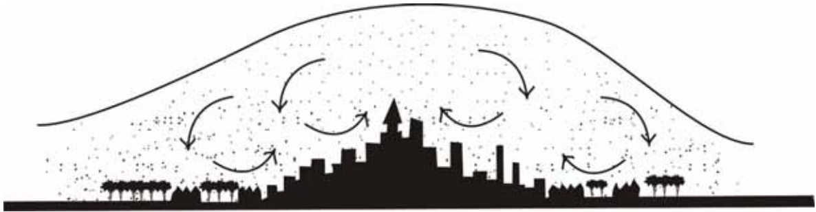
Figura 14: Corte esquemático de uma área urbana sob efeito das ilhas de calor. Adaptado de Hough, 1998.
