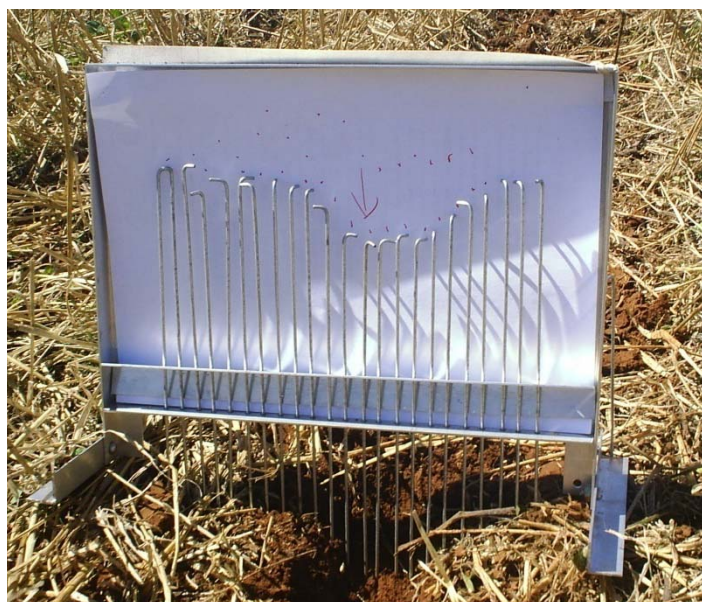
Figura 2 - Microperfilômetro desenvolvido para determinação do perfil de solo mobilizado. Santa Maria/RS, 2007.
