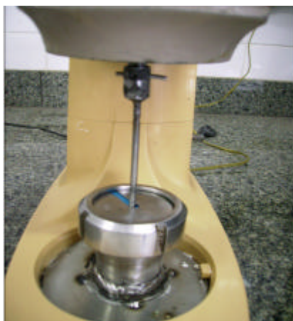
Figura 4: Batedeira adaptada para produção de pão com 35 g de farinha
