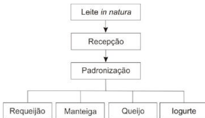
Figura 6 – Fluxograma do processo industrial do laticínio.
