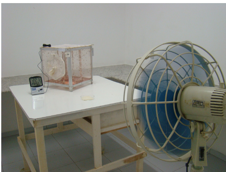
Figura 1 - Tratamento aromático de machos estéreis da mosca-da-fruta, Ceratitis capitata (gaiola) com óleo de gengibre (placa de Petri) em uma sala de 23 m 3
