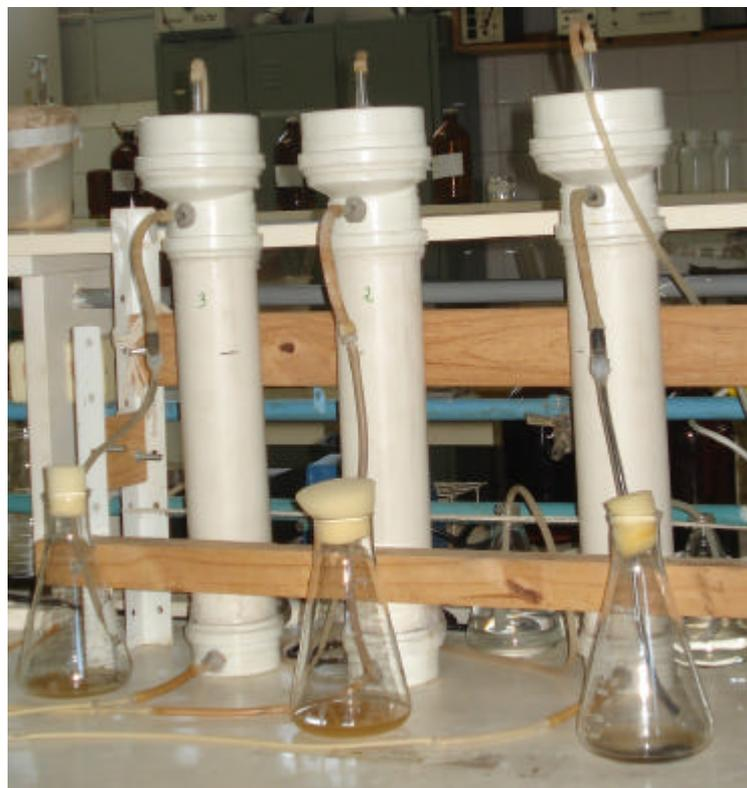
Figura 4 – Filtro anaeróbio de fluxo ascendente.
