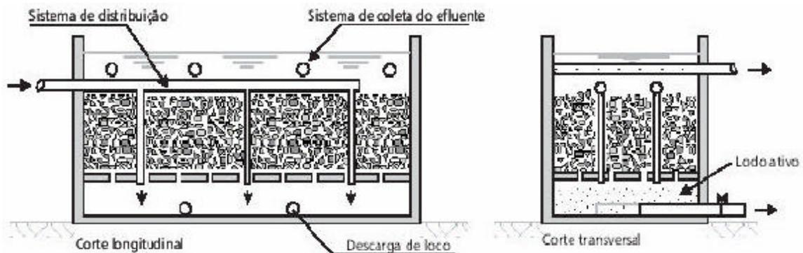
Figura 3 – Filtro anaeróbio.
