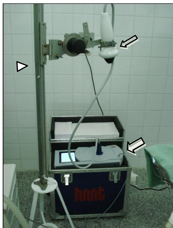
Figura 2: Gerador de ondas de choque extracorpóreas eletrohidráulico portátil (Versatron®-HMT) montado sobre um tripé, para otimizar a distância da probe da pele da face.
