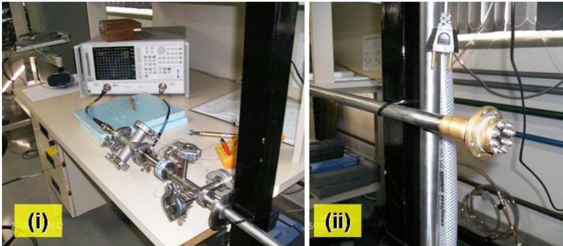
Figura 5.11 – Detalhes da montagem experimental utilizada para medições em modo de reflexão: (i) conexão do cabo coaxial ao VNA 8722ES; (ii) sistema de fixação da cavidade com tampa na câmara experimental.
