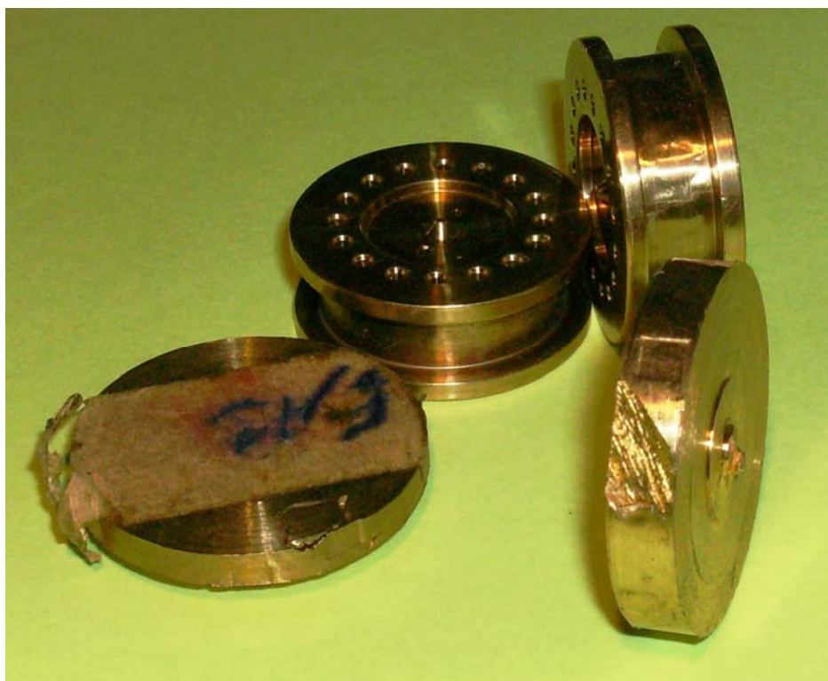
Figura 4.10 – Falhas estruturais (“bolhas” internas) no CuAl(6%) observadas durante o processo de usinagem mecânica.
