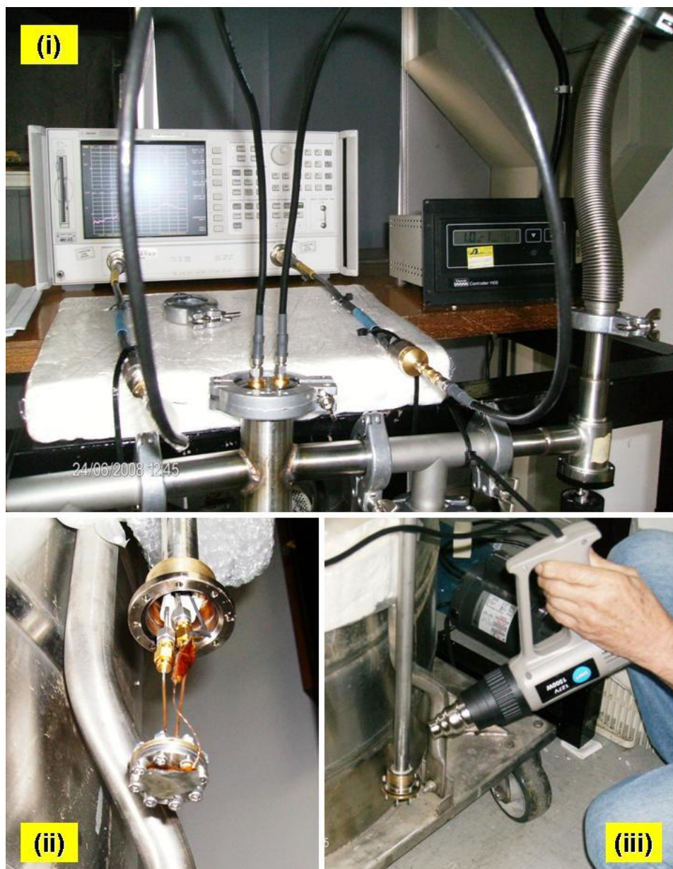
Figura 5.46 – Montagem experimental utilizada nas medições de freqüência de ressonância e fator-Q carregado em modo de transmissão: (i) analisador de rede vetorial Agilent Modelo 8722/ES com a linha de transmissão (composta pelos cabos de teste flexíveis conectados aos cabos coaxiais do criostato) fixada à estrutura metálica; (ii) detalhe da montagem da cavidade; (iii) detalhe da câmara experimental durante o processo de degaseificação para introdução no dewar .
