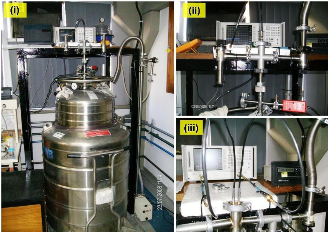
Figura 5.22 – Vista geral da montagem do sistema de medição: (i) analisador de rede vetorial Agilent Modelo 8722/ES apoiado sobre uma plataforma fixada a uma estrutura metálica; (ii) detalhe da fixação do criostato a estrutura metálica; (iii) detalhe da fixação da linha de transmissão (composta pelos cabos de testes flexíveis do analisador de rede conectados aos cabos coaxiais) fixada à estrutura metálica.
