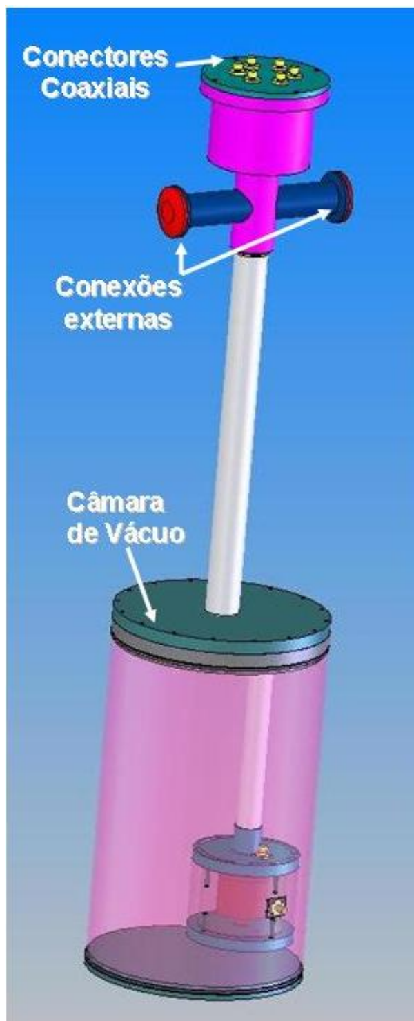
Figura 6.7 – Montagem do ressonador de safira no interior do criostato construído para medições em 77K.
