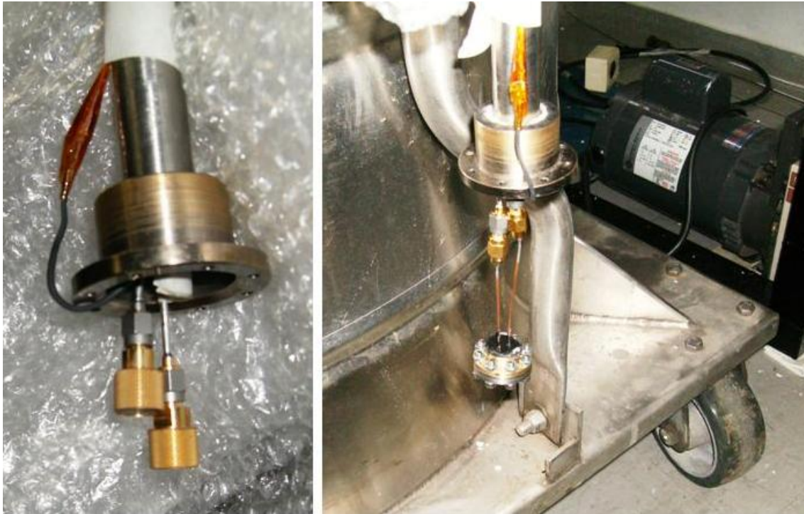
Figura 5.16 – Detalhes das conexões das sondas, feitas com cabos coaxiais UT47 , aos cabos coaxiais UT85 do criostato.
