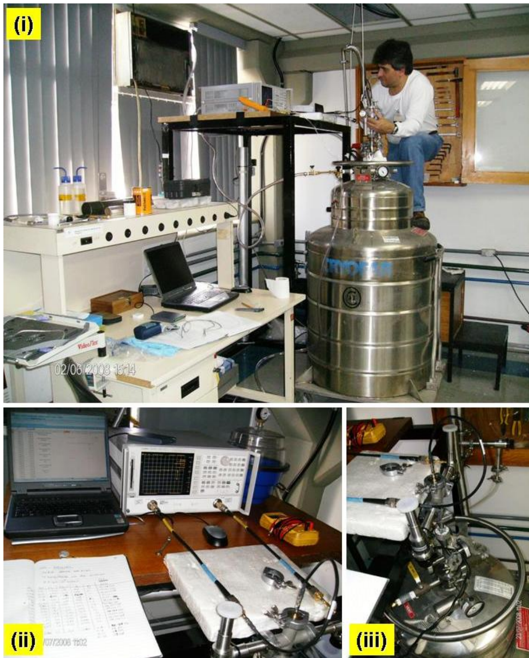
Figura 5.28 – Montagem experimental utilizada nas medições de frequência de ressonância e fator-Q carregado em modo de reflexão: (i) vista do criostato mantido no interior do tanque de LHe ; (ii) analisador de rede vetorial Agilent Modelo 8722/ES com a linha de transmissão (composta pelo cabo de teste flexível do analisador de rede conectado ao cabo coaxial do criostato) fixada à estrutura metálica; (iii) detalhe da fixação do criostato e da linha de transmissão a estrutura metálica.
