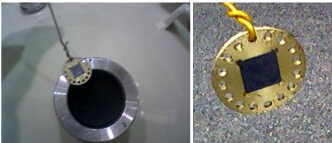
Figura 4.46 – Testes criogênicos e de choque térmico realizados para verificar os efeitos das contrações diferenciais sobre o Silício e a cola superbonder .
