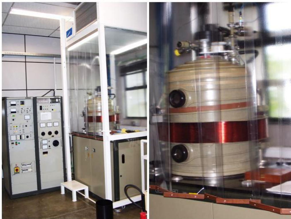
Figura 4.56 – Sputtering Balzers BA510 utilizado nas deposições de Nióbio em \text{CuAl}(6\%) e Silício, realizadas pelo Laboratório de Microfabricação do Laboratório Nacional de Luz Síncrotron (LMF - LNLS).
