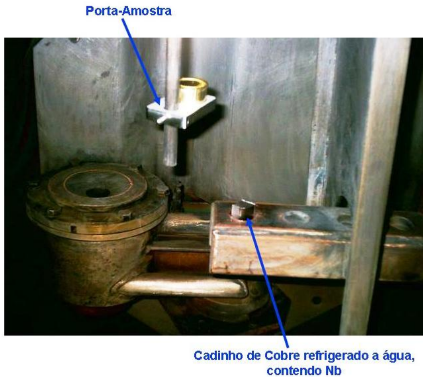
Figura 4.50 – Montagem utilizada para deposição de filmes de Nióbio por EB-PVD.
