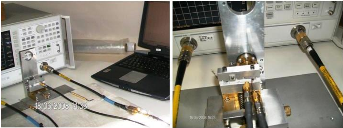
Figura 5.14 – Detalhes da montagem experimental utilizada para medições em modo de transmissão: as posições das sondas foram definidas de forma a obter acoplamentos eletromagnéticos próximos de um em 4,2K .
