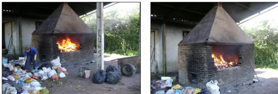
Figura 63- Forno utilizado na incineração dos resíduos/rejeito.
