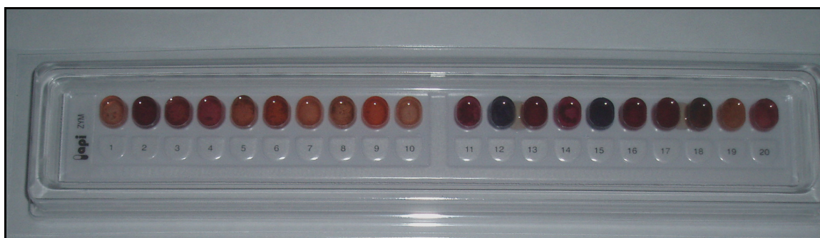
Figura 31. Fotografia da galeria API-ZYM (Biomeriëux, França) utilizada na determinação da atividade das enzimas \beta -glucosidase, \beta -glucuronidase e \beta -galactosidase.
