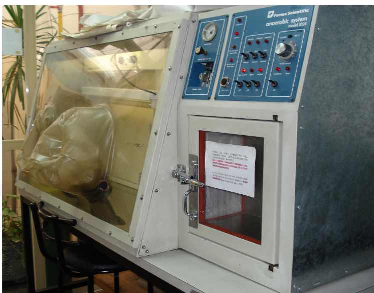
Figura 4. Fotografia da câmara de anaerobiose (Forma Scientific Anaerobic System, modelo 1024).
