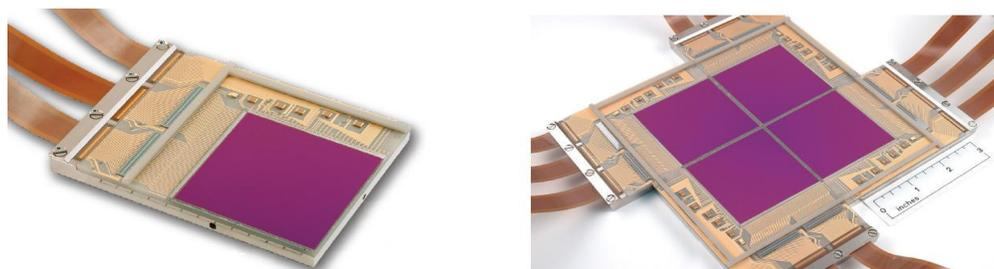
FIG. 1.27 - Sensor Orion da Raytheon Vision Systems. No lado esquerdo aparece uma foto do sensor Orion, com uma matriz de 2048x2048 elementos. No lado direito observa-se uma configuração de quatro sensores Orion, colocados lado a lado, formando uma matriz de 4096 x 4096 elementos (RAYTHEON, 2008).
