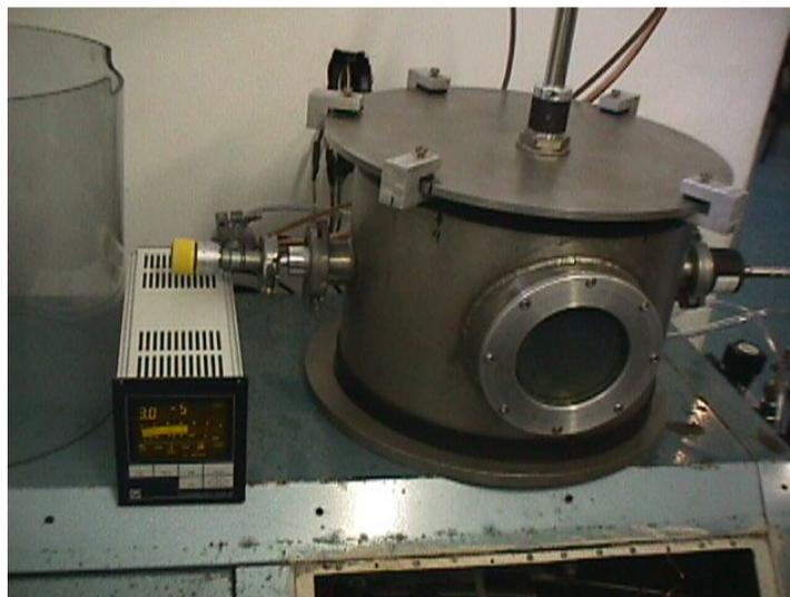
FIG. 7.2 - Fotografia do sistema de deposição por pulverização catódica antigo.
