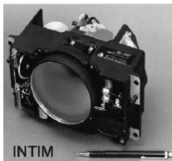
FIG 1.16 - Equipamento portátil de imageamento térmico INTIM (SARUSI, 2003)
