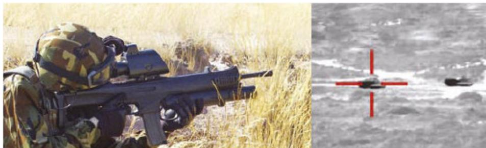
FIG. 1.11 – Luneta de pontaria ASPIS, fabricada pela Selex/Galileo Avionica (Itália), pesando 1 Kg e dotada de um apontador laser, possibilita ao combatente a observação e a pontaria tanto diurna (espectro visível) como noturna (infravermelho de 8 a 12  $\mu\text{m}$ )(SELEX, 2006).
