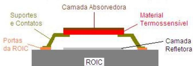
FIG. 4.6 – Configuração básica de um microbolômetro, elemento de uma matriz de termodetectores.
