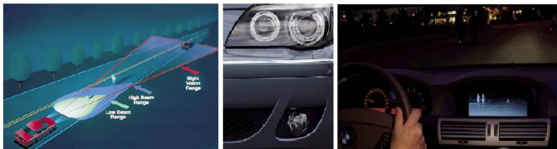
FIG. 1.9 - À esquerda, a representação do aumento de profundidade do campo visual, proporcionado por uma câmera infravermelha (GM, 2006). A figura também apresenta a frente do BMW série 7 (ao centro), dotado de uma câmera infravermelha acoplada na parte inferior esquerda do pára-choque dianteiro e uma imagem térmica no seu monitor (à direita), no painel do veículo (MOTORING, 2006).
