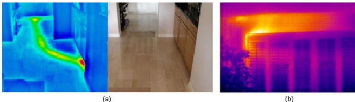
FIG. 1.8 – a) identificação de tubulação de água quente sob o piso; b) localização de falha no isolamento térmico de uma casa (IMAGING1, 2006).
