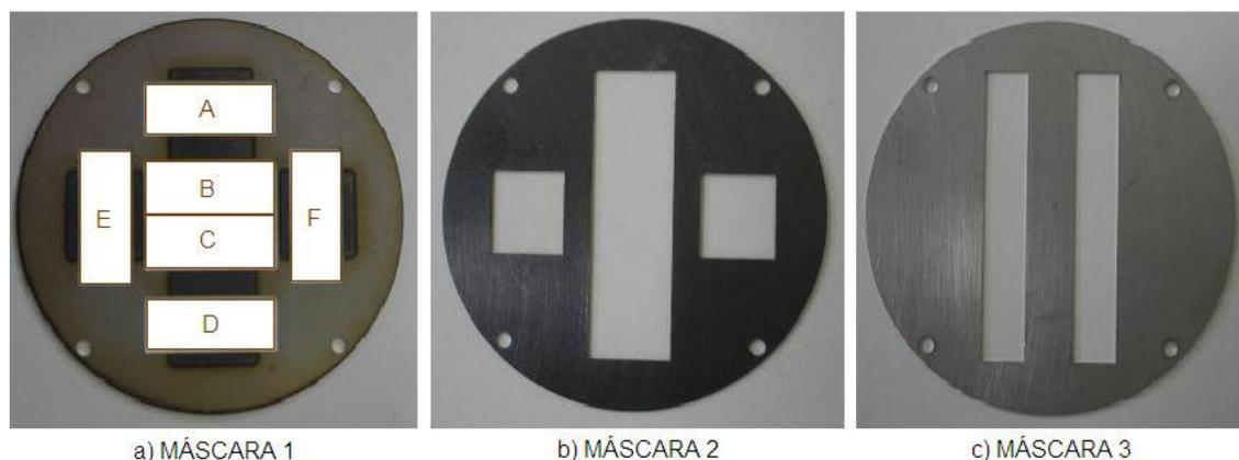
FIG. 7.5 – Máscaras utilizadas para a produção dos filmes de VO<sub>x</sub>: a) Máscara 1; b) Máscara 2; c) Máscara 3.
