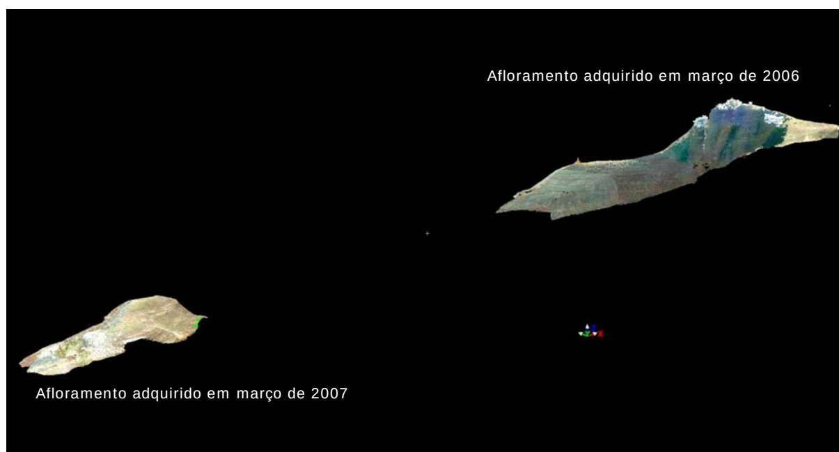
Figura 4-26 – Nuvem de pontos registrada das duas aquisições com tratamento, apresentando como textura a imagem obtida com o Laser Scanner .
