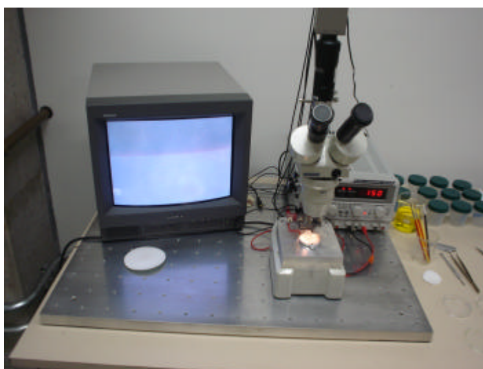
Figura 20 – Arranjo para triagem e amputação dos espécimes: Lupa estereoscópica com magnificação de 30x acoplada a um monitor onde foi possível observar detalhes dos espécimes durante sua manipulação. Nesta imagem também são observados uma fonte de alimentação e o aparato utilizado para o resfriamento das planárias durante sua amputação.
