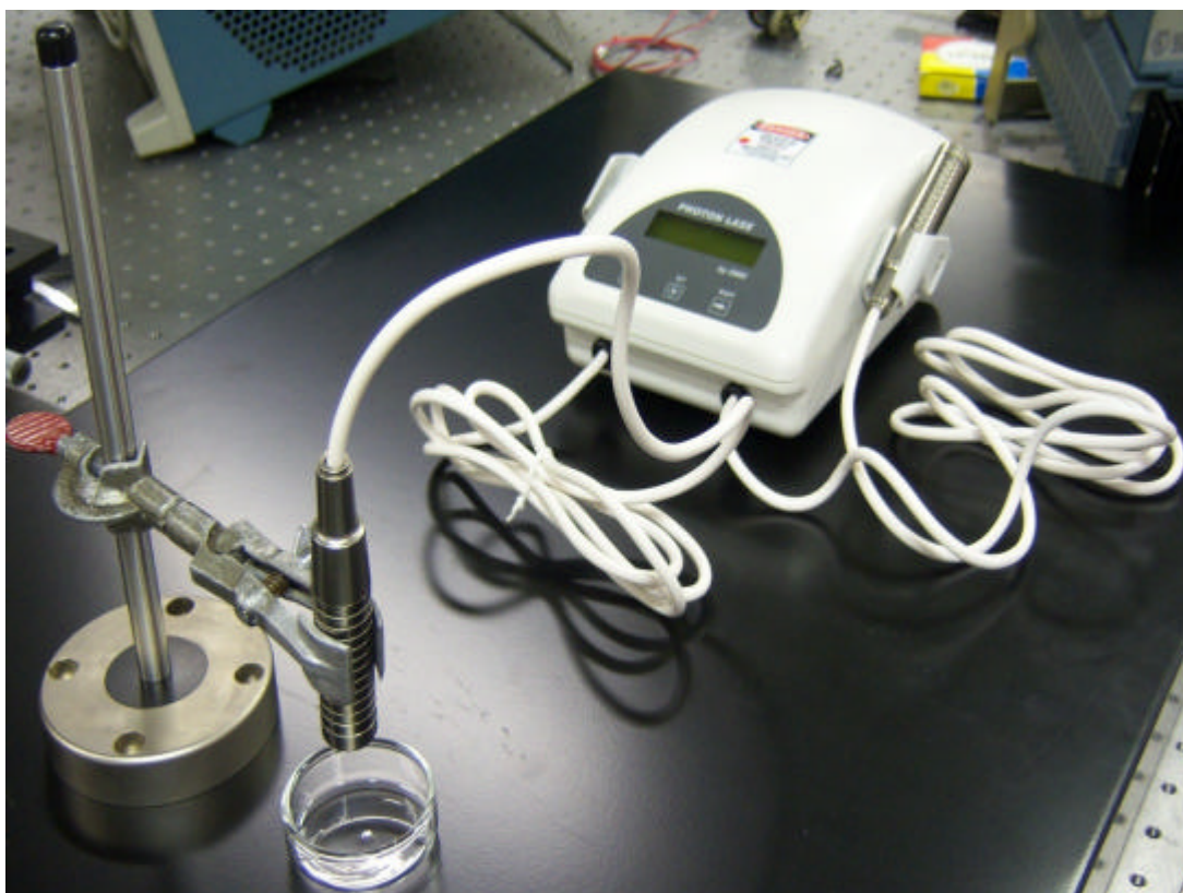
Figura 21 – Esquema da montagem do sistema de suporte mecânico para irradiação com laser no experimento.
