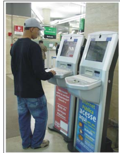
Fig. 34: A tela de cristal líquido permitiu uma forma mais delgada do equipamento.
