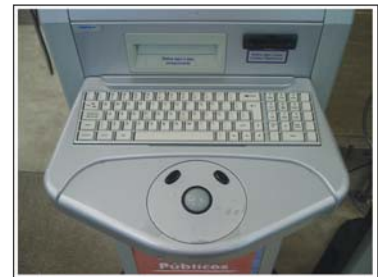
Fig. 06: Detalhe do teclado acoplado e do tracking ball utilizado para orientar o cursor no modelo com telefonia.
